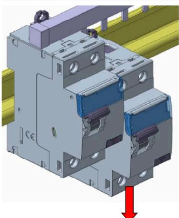
Tirer l'appareil vers l'avant afin de le dégager du rail
